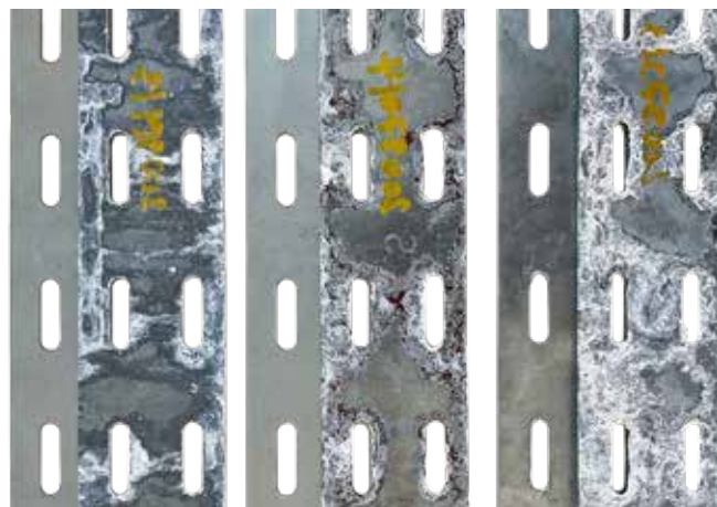
ZM - kontinuierliche Verzinkung mit Magnesium und Aluminiumbeimischung
