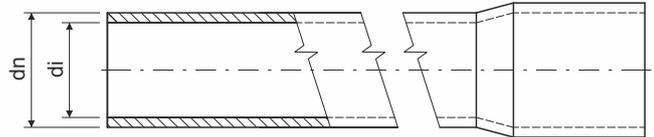
Produktbeschreibung: Kunststoffstangenrohr, flammwidrig, mit angeformter Muffe
