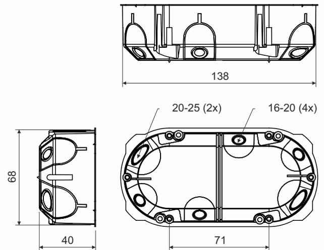
Produktbeschreibung: geeignet für Leitungen mit einer Spannung bis 400V und einer Stromstärke bis max. 16 A
