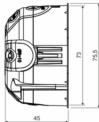
Produktbeschreibung: geeignet für Leitungen mit einer Spannung bis 400V und einer Stromstärke bis max. 16 A
