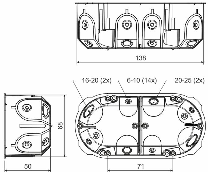
**Produktbeschreibung:** geeignet für Leitungen mit einer Spannung bis 400 V und einer Stromstärke bis max. 16 A
