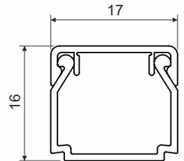
Produktbeschreibung: bestimmt zur Installation von Niederspannungsleitungen
