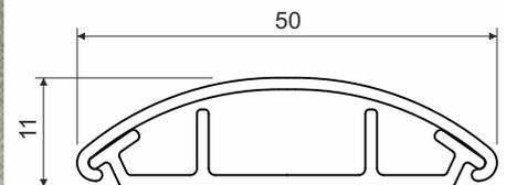
Produktbeschreibung: geeignet zur Verlegung von Niederspannungsleitungen
