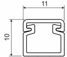
Produktbeschreibung:: bestimmt zur Installation von Niederspannungsleitungen
