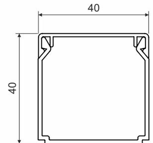
Produktbeschreibung: bestimmt zur Installation von Niederspannungsleitungen
