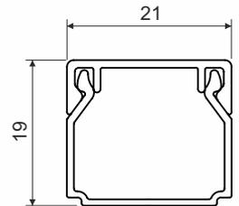
**Produktbeschreibung:** bestimmt zur Installation von Niederspannungsleitungen
