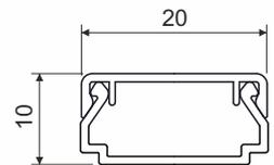
**Produktbeschreibung:** geeignet zur Verlegung von Niederspannungsleitungen
