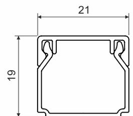
**Produktbeschreibung:** geeignet zur Verlegung von Niederspannungsleitungen
