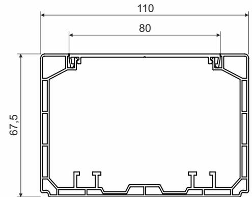
Produktbeschreibung: vorgesehen für die Installation von Niederspannungsleitungen
