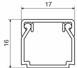
**Produktbeschreibung:** bestimmt zur Installation von Niederspannungsleitungen
