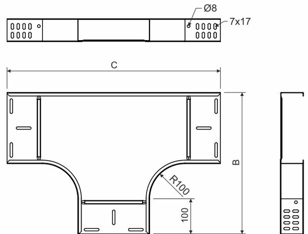
**Produktbeschreibung:** Das T-Stück dient zum Abzweigen von JUPITER Kabelrinnen oder Kabelleitern gleicher Breite. Die Verbindung erfolgt mit den Schraube NSM 6X10. Zum Schutz der Kabel sind die Schraubenköpfe auf der Innenseite der Kabelrinne/Kabelleiter vorzusehen.
